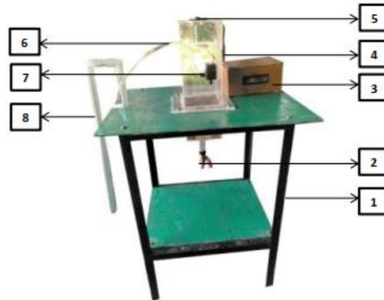
Gambar 2. Hasil Rancangan Separator Minyak Serai Wangi
