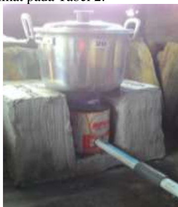
Gambar 4. Kompor untuk Memanfaatkan Biogas Kotoran Sapi
