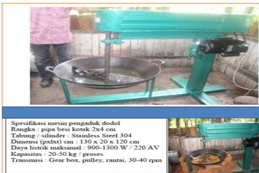
Gambar 1. Mesin Pengaduk Adonan Gelamai dan Komponen-komponennya
