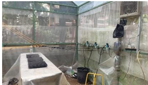
Gambar 2. Rangkaian Alat Variasi Ketinggian Penyiraman pada Persemaian
