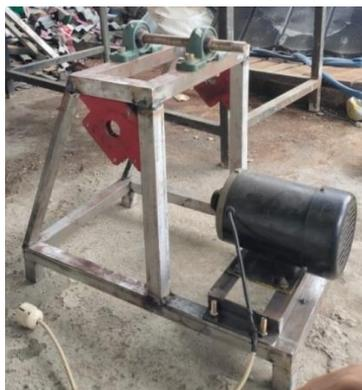
Gambar 2. Kerangka Alat
