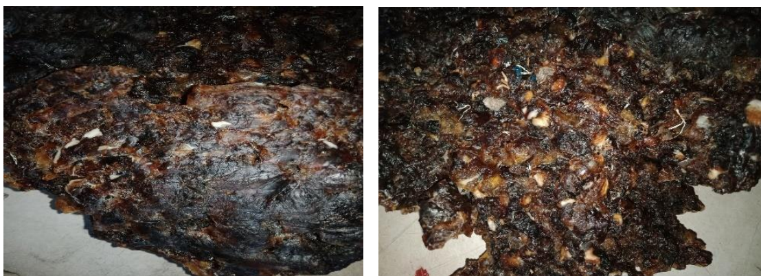
Gambar 1. Cacat white spot pada SIR 20
