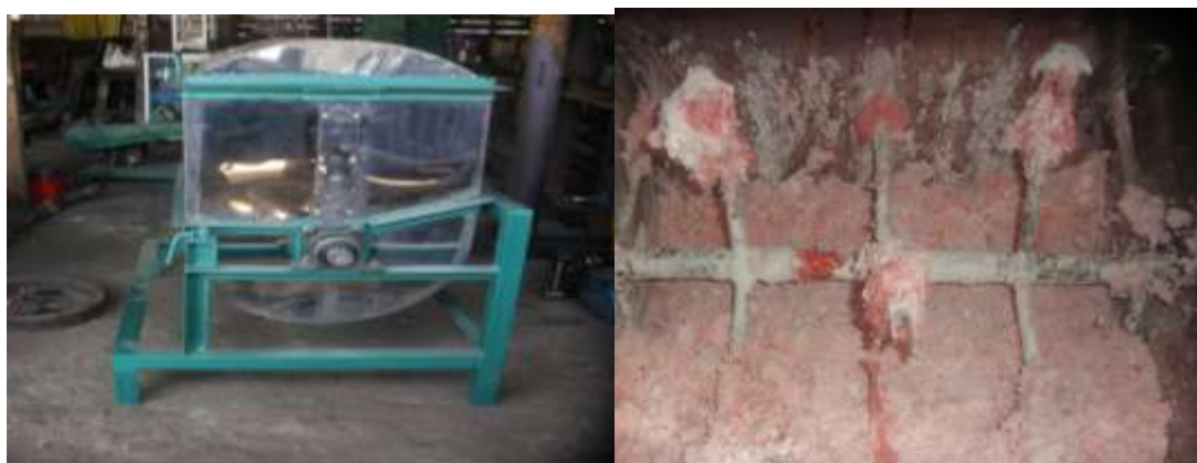
(a) (b) Gambar 2. Mesin Pencampuran Adonan Kerupuk Merah (a) dan Proses Pengadukannya (b)
