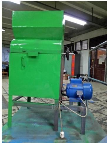
Gambar 5. Rangka utama mesin pengupasan pinang
