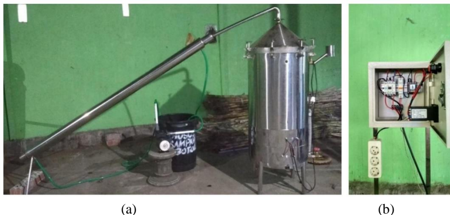
Gambar 2. Destilator elektrik: (a) destilator; (b) sistem kontrol temperatur
