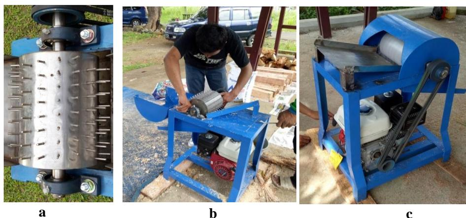
Gambar 1. Komponen Silinder Parut (a) dan Konstruksi Mesin Secara Keseluruhan (b dan c)
