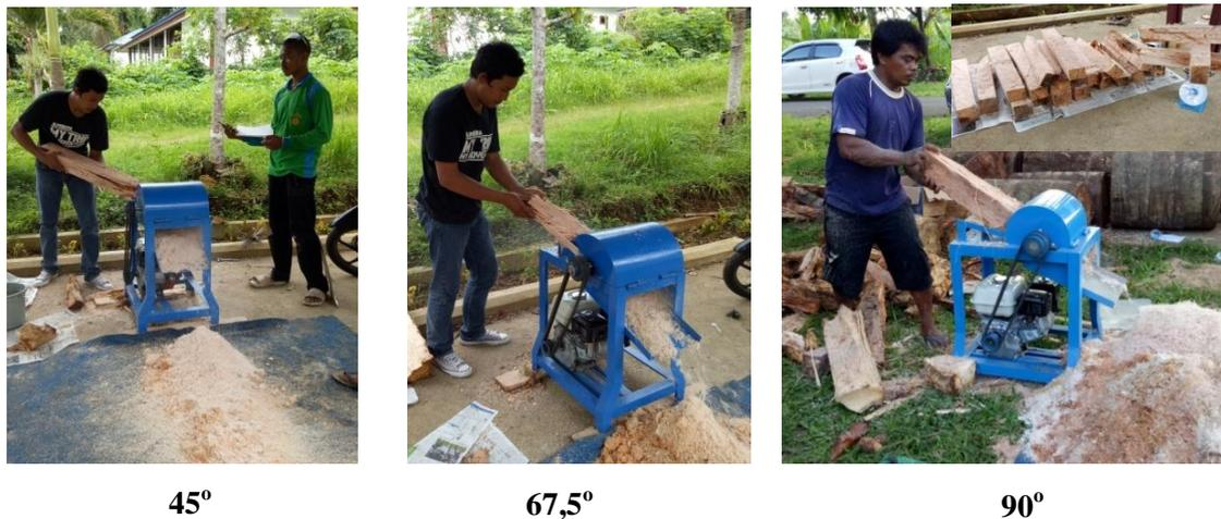
Gambar 5. Pengujian Performansi berbagai Metode Pengumpanan Bahan
