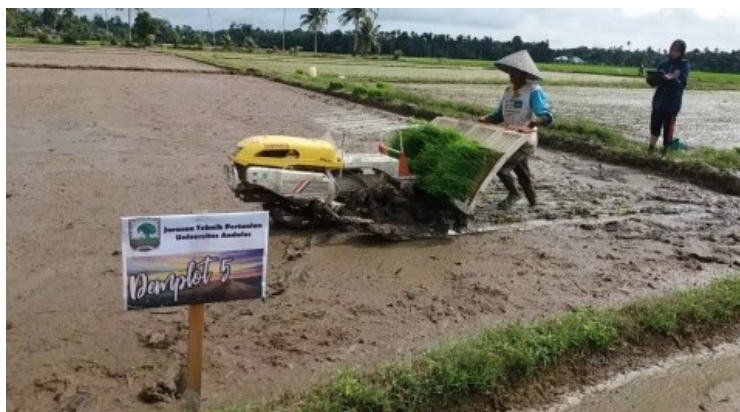
Gambar 2. Proses penanaman padi menggunakan rice transplanter
